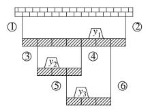
Die Kabel 1 und 2 können je 300 kg Last, die Kabel 3 und 4 je 100 kg und die Kabel 5 und 6 jeweils 50 kg Last tragen. Unter Vernachlässigung des Gewichtes der Kabel und der Bohlen soll das maximal zulässige Gesamtgewicht  $y_1 + y_2 + y_3$  für die Lasten gefunden werden.
