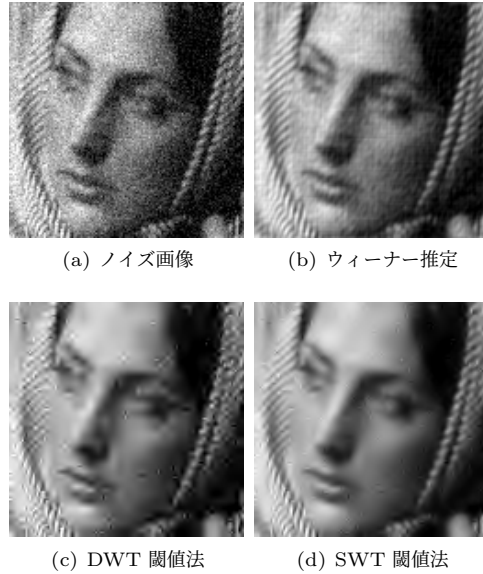
図 2 ウェーブレットによる画像ノイズ除去の例
